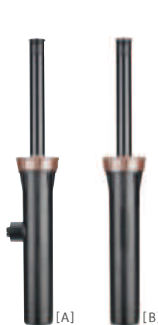
[A] PROS-06-PRS30 [B] PROS-06-NSI-PRS30 Całkowita wysokość po wsunięciu: 22,5 cm Część wynurzalna: 15 cm Średnica zewnętrzna: 5,7 cm Rozmiar wejścia: 1/2"
